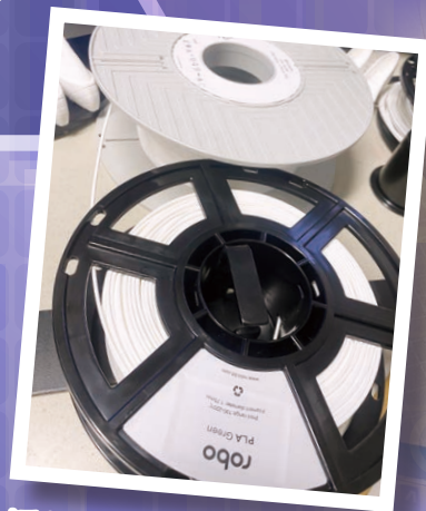
透過3D打印教學，學生還有機會接觸不同的打印物料，從中理解不同物料的特性。圖中所見是3D打印常用的物料：聚乳酸（英語：Polylactic Acid 或 Polylactide，縮寫：PLA），無毒亦能分解。
