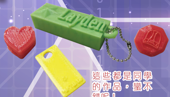
透過3D打印教學，學生還有機會接觸不同的打印物料，從中理解不同物料的特性。圖中所見是3D打印常用的物料：聚乳酸（英語：Polylactic Acid 或 Polylactide，縮寫：PLA），無毒亦能分解。
